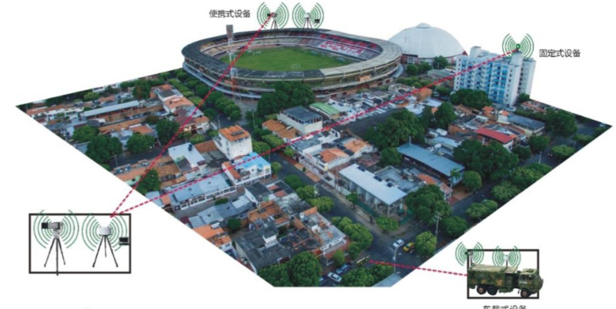
察打一体反无人机系统由无线电侦测设备（频谱探测设备）、光电干扰一体化设备、指控终端平台以及便携式干扰枪组成。系统集目标探测、跟踪识别、指挥控制、打击处置功能于一体，系统集成度高，适用性强，扩展性好，可不受气候条件限制全天时工作。系统可通过全IP网络化部署实现低空广域覆盖及与地面安防监控系统的无缝集成。系统主要应用于重点目标和大型活动的低空安防，可有效应对随着低空空域开放及无人机广泛应用而日益增长的各类公共安全威胁。
